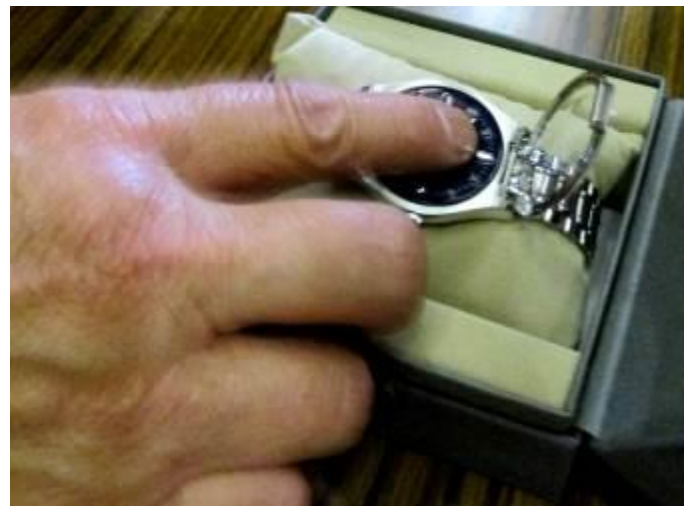
視覚障がい者用の腕時計です。文字盤に刻まれた凸部分に触れて時を読みます。
